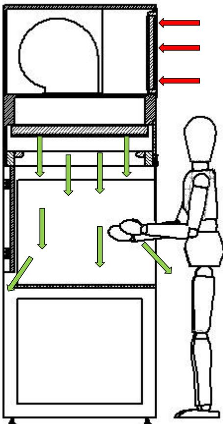
Die Umgebungsluft wird über einen Vorfilter angesaugt und strömt durch einen Hochleistungs-Schwebstoff-Filter vertikal in den Arbeitsbereich. Diese Reinluftströmung wird durch eine allseitige Einhausung (Seitenscheiben und Frontseite mit Klappscheibe) laminar durch den Arbeitsbereich geführt. Über die Arbeitsfläche tritt der Luftstrom vorne und hinten aus dem reinen Arbeitsbereich aus.
