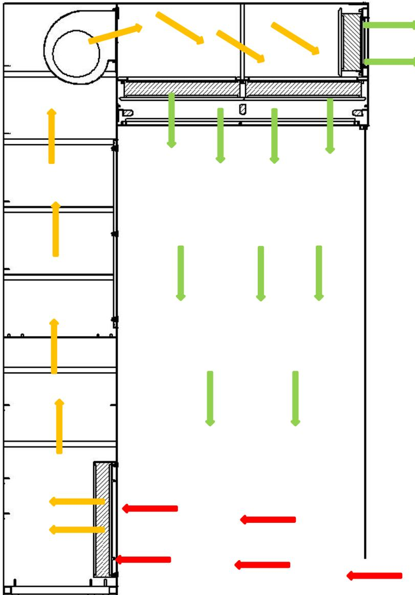
Die Luft aus dem Arbeitsraum wird über die Vorfilter in den Umluftkanal angesaugt. Von dort wird sie über die Ventilatoren in das Plenum eingeblasen, hier strömt sie durch die Hochleistungs Schwebstofffilter zurück in den Arbeitsbereich. Ein Teil der Luft aus dem Plenum wird über Hochleistungs Schwebstofffilter zurück in den Raum ausgeblasen.
